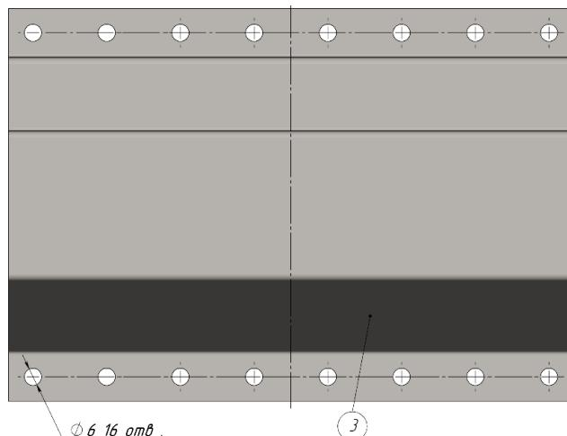
Удалить заусенцы в отверстиях с обеих сторон ремонтной вставки (3).
