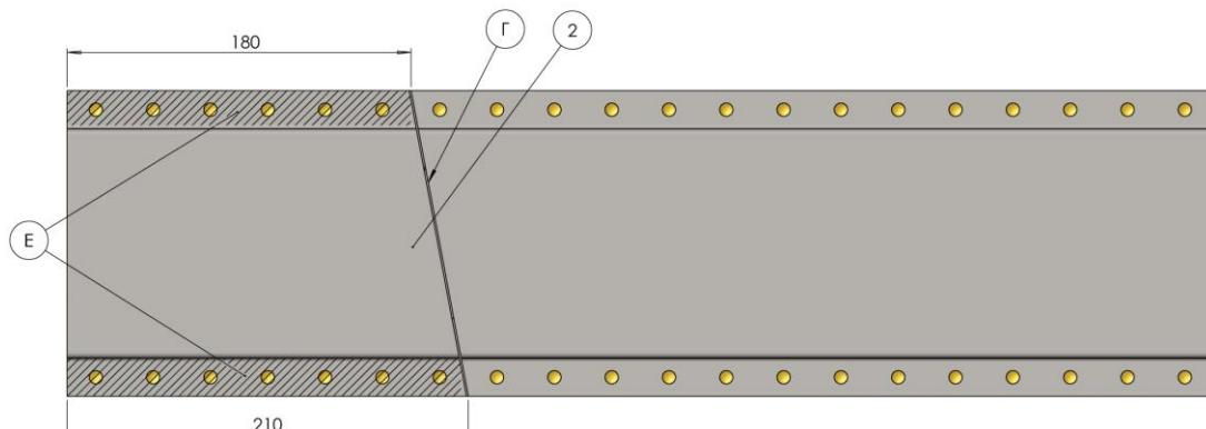
Схема снятия части панели
