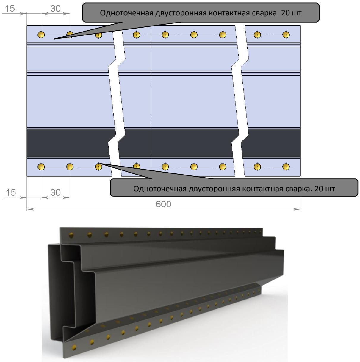
*Коробчатая конструкция, имитирующая структурные элементы нижней части боковины кузова автомобиля (порог)*
