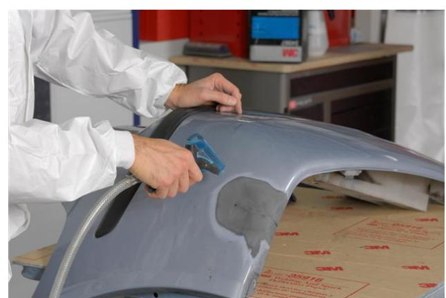
Удалить лакокрасочное покрытие вокруг места ремонта, а так же во внутренней части элемента:
