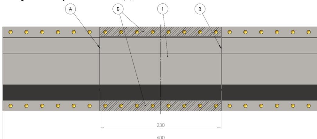
Схема снятия части панели
