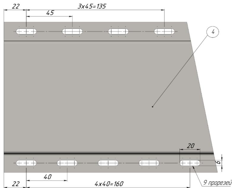
Удалить заусенцы в отверстиях с обеих сторон ремонтной вставки (4).
