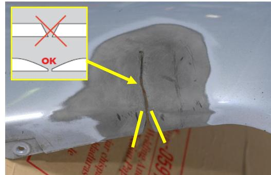
Расшлифовать кромки трещины с лицевой стороны для увеличения адгезии к ремонтируемой детали и достижения наилучшего качества ремонта.
