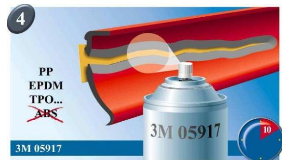
Во время сушки активатора приготовьте состав FPRM (вручную на шпателья – использование тюбиков 150 мл или при помощи пистолета – использование картриджей 50 мл) для нанесения, а также армирующую ленту (стеклоканку)
